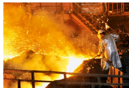
Canale di colata
