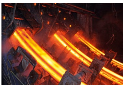
Impianto di colata continua
