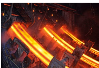
Planta de colada continua
